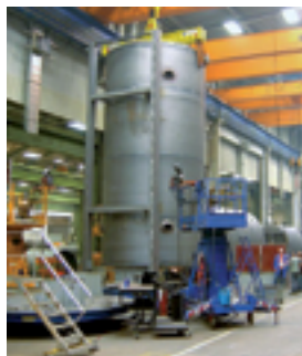
Soudage de la pièce en position verticale
