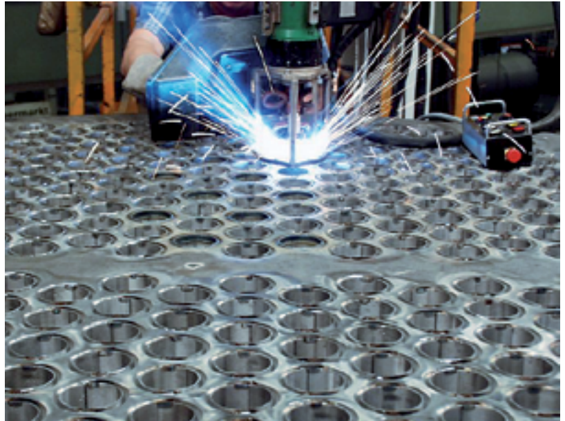
Soudage de tube de fumées avec appareils de soudage mécaniques
